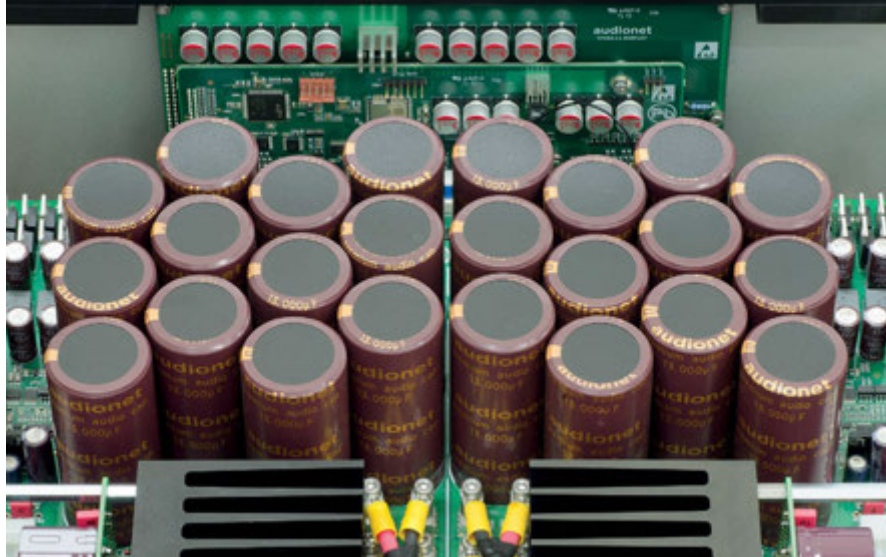
La sezione di potenza di ciascun canale dispone di 12 elettrolitici di filtraggio da 13.000 µF, per uno storage effettivo a riposo di oltre 460+460 joule, valore molto alto in assoluto e tra i più alti mai riscontrati in un componente a stato solido. La sezione pre dispone di altri 2+2 elettrolitici principali da 22.000 µF, e l'ammontare complessivo delle celle di filtro si aggira intorno a 0,4 farad.
